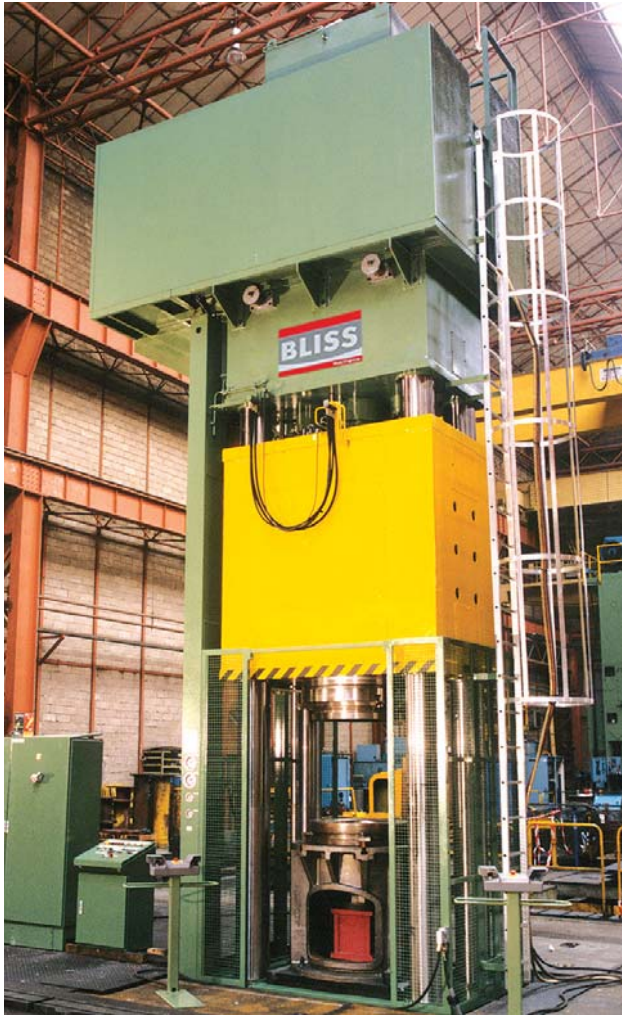
PHDC 450 Presse double effets supérieur (300/150 tonnes), capable de réaliser des emboutis très profonds, comme par exemple des bouteilles d'oxygène.
