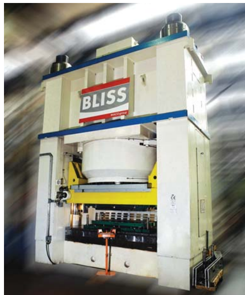
PHS 6000 Die leistungsstarke BLISS-Pressen, 6000 Tonnen, auf einem Zylinder mit einem Durchmesser von 1600 mm, um das Gaufrieren von rostfreien Platten für Wärmeaustauscher durchzuführen. Besonders konzipierter Rahmen, um das homogene Pressen für die gesamte Oberfläche des Werkteils zu gewährleisten.
