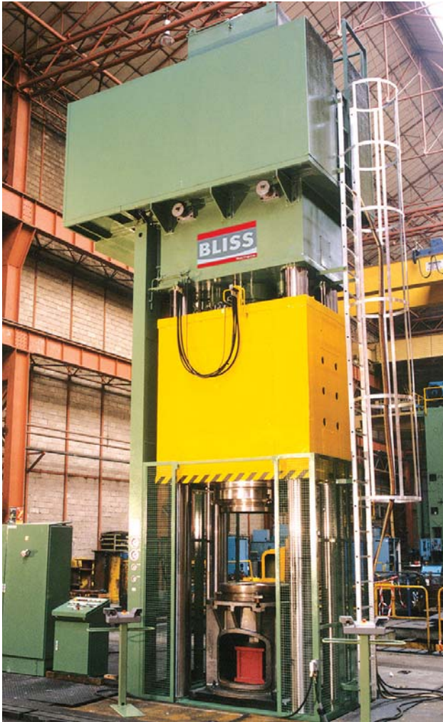
PHDC 450 Hochleistungspressen mit Doppelleffekt (300/150 Tonnen), die sehr tiefe Ziehtelle herstellen kann, wie z. B. Sauerstoffflaschen.
